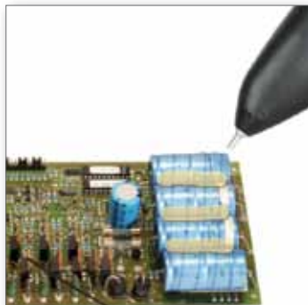
Corrección de vibraciones en tarjetas de circuitos
