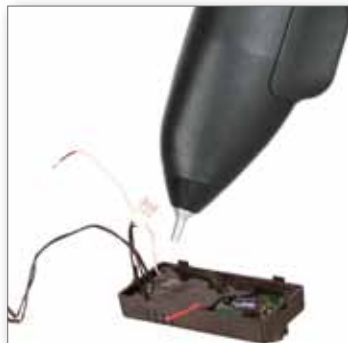
Encapsulado de componentes en tarjetas de circuitos
