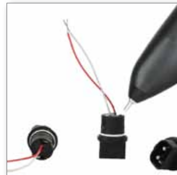
Relleno y sellado de conmutadores, etc
